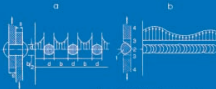
1 - spoina, 2 - strefa przegrzania, 3 - strefa wytrzymałości, 4 - strefa niezmiennona spawaniem. Złącza spawane
