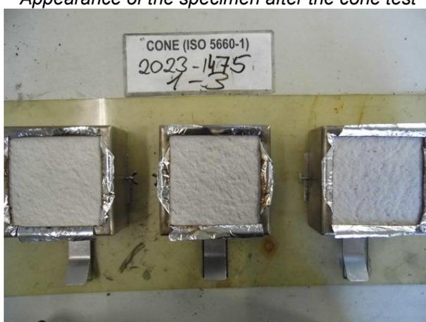
Aussehen der Proben nach dem Rauchdichteversuch
