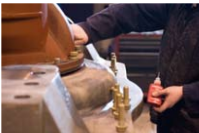
22 śruby mocujące wał różnicowy do tylnej osi są przymocowane przy pomocy Loctite® 648
