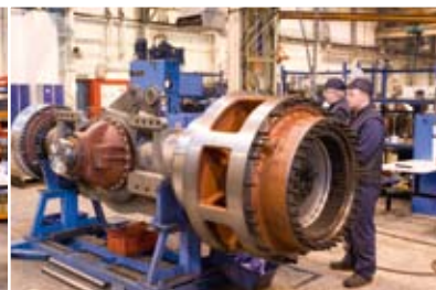
Tylna oś gotowa do kolejnego etapu montażu
