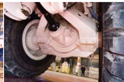
Montaż przekładni w 100 tonowej ciężarówce
