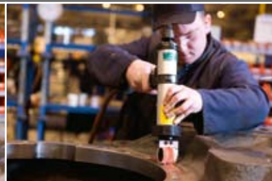
Uszczelnianie złącza kołnierzowego tylnej osi mechanizmu różnicowego przy pomocy Loctite® 518
