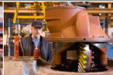
Mechanizm różnicowy jest gotowy do montażu
