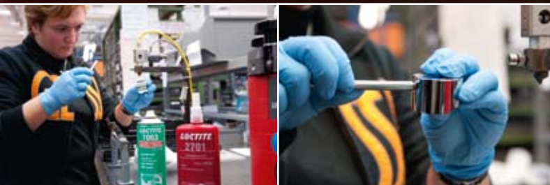
Loctite® 2701 stosowany do pasywowania powierzchni metalowych
