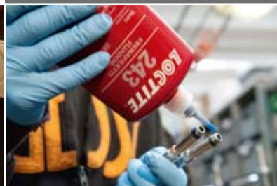
Montaż baterii do zlewów kuchennych przy pomocy Loctite® 243
