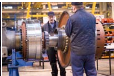
Montaż przekładni i zawieszania
