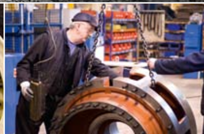
Zawieszenie koła od 100 tonowej ciężarówki
