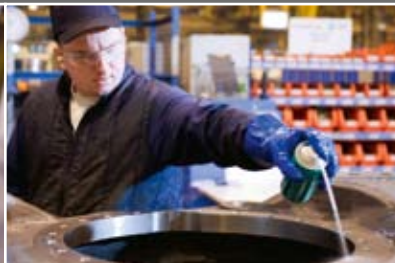
Czyszczenie złącza kołnierzowego na tylnej osi mechanizmu różnicowego przy pomocy Loctite® 7063
