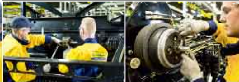
Śruby głównej przekładni młocarni są mocno dokręcane, aby zapewnić ich maksymalną niezawodność
