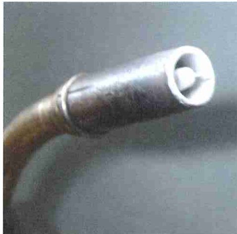
Rys. 2. Widok końcówki uchwytu spawalniczego MAG z naniesioną powłoką ochronną preparatem Aerodag Ceramishield.
