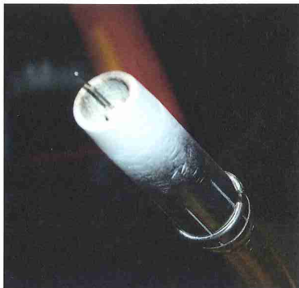
Rys. 12. Widok dyszy i końcówki prądowej z naniesionym preparatem Aerodag Ceramishield po procesie spawania (5 min) metodą MIG.
