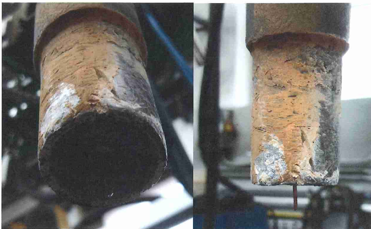
Rys. 9. Widok dyszy i końcówki prądowej z naniesionym preparatem Aerodag Ceramishield po procesie napawania (10 min) metodą MAG.
