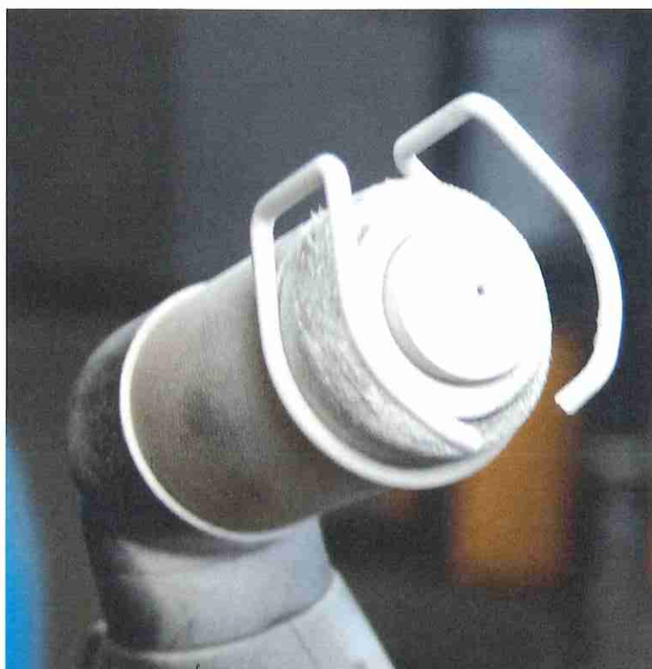
Rys. 15. Widok dyszy plazmowej, osłonki i przewodnika z naniesionym preparatem Aerodag Ceramishield przed procesem cięcia plazmowego
