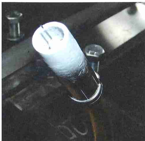
Rys. 11. Widok dyszy i końcówki prądowej z naniesionym preparatem Aerodag Ceramishield przed procesem spawania
