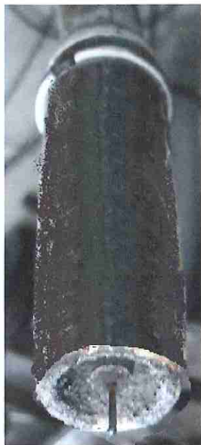
Rys.10. Widok dyszy i końcówki prądowej po procesie spawania (5 min) metodą MIG bez powłoki Aerodag Ceramishield. Widoczne przyklejone odpryski.
