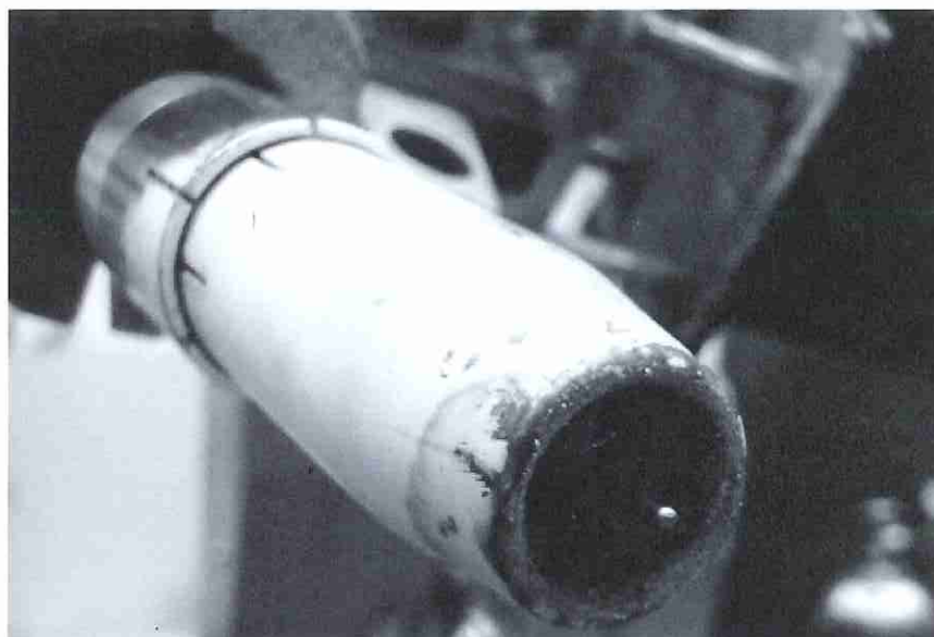
Rys.6. Widok dyszy i końcówki prądowej z naniesionym preparatem Aerodag Ceramishield po procesie spawania i oczyszczeniu z odprysków.
