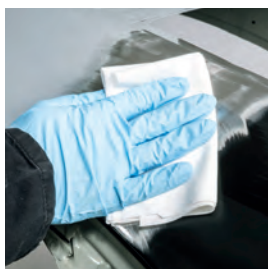
Oczyszczenie i przygotowanie powierzchni za pomocą TEROSON VR 20
